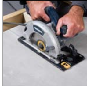
Scie circulaire avec lame pour béton et maçonnerie ou lames à dents de Carborundum.
